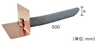
連結式の改修工事用横型銅製ドレン。丸棒部でドレンキャップと連結し、既存ドレン上に設置することで二重ドレンシステムとなる。専用アンカー付属。
