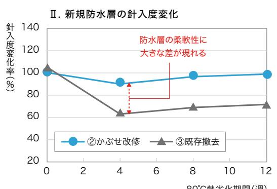
アスファルト系下地処理を用いたかぶせ改修を行うことで、既存層・新規層ともに延命効果が期待できます。
