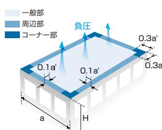
②屋根にかかる風圧力は、以下の計算式により求められます。
