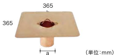
連結式の改修工事用たて型銅製ドレン。丸棒部でドレンキャップと連結する。既存ドレン上に設置することで二重ドレンシステムとなる。専用アンカー付属。
