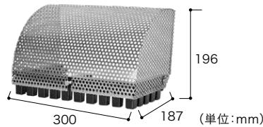
ベース部は鋳鉄製、上部はステンレスパンチングメタル製のドレンキャップ。約5kgの自重がある据置型で、耐風性に優れる。
