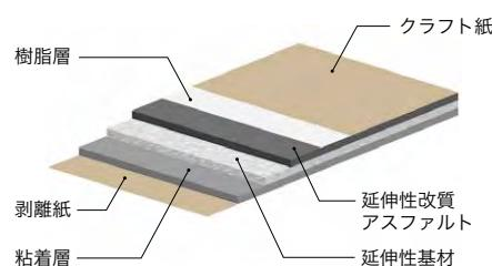
断熱工法に使用する防湿層兼断熱材固定用シート。
