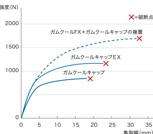
ガムクール防水層は、下地の大きな挙動に対して十分な強度と耐久性を有しています。
