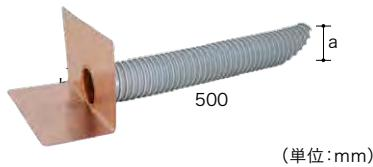
改修工事用横型銅製ドレン。既存ドレンの上に設置することで二重ドレンシステムとなる。専用アンカー付属。
