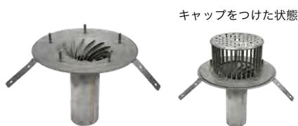
改修用排水量改善たて型二重ドレン。排水口の羽根形状で排水量を増加する画期的な構造。新築時の直径100mm縦引きドレンと同等の排水力。
