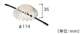
アルミダイキャスト製縦引き用ドレンキャップ。ステンレス製板バネ(樹脂製滑り止め付)をドレン内部に差し込んで設置。
