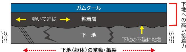
ガムロン粘着層は、上からの加圧で接着面の細部に広がります。施工時に転圧することで、改質アスファルト素材の粘着層が水みちを埋め、より高い水密性を確保します。
