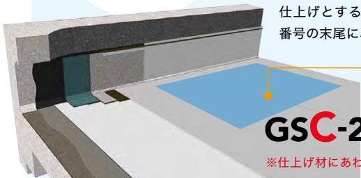
適用下地に合わせたガムクール防水各仕様の上に、板状の仕上げ材を敷設することで軽歩行仕上げとすることができます。その場合、仕様番号の末尾に、仕上げ材の番号を追加します。
