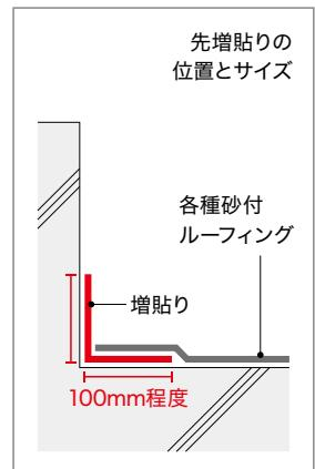
※1 後増貼りの場合、平面部の砂付ルーフィング施工後にアクアベース(1.0kg/m<sup>2</sup>)→メッシュJK増貼り→アクアベース(1.0kg/m<sup>2</sup>)の手順で施工します。
