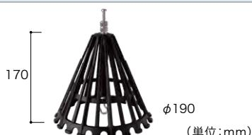
リードレンZ専用の連結式縦引用キャップ。軸芯部のJフックをリードレンZの丸棒部に掛け、Wナット締めで連結固定する。アルミダイキャスト製。
