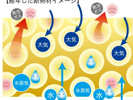
時間が経つごとに気泡内のガスが抜け、ガスより断熱性の低い大気に入れ替わります。断熱材が吸湿吸水した場合も断熱性が低下します。
