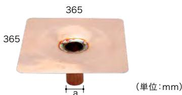
改修工事用たて型銅製ドレン。既存ドレンの上に設置することで二重ドレンシステムとなる。専用アンカー付属。
