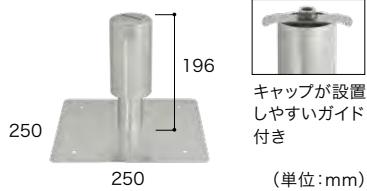
防水層のフクレを解消するための平面部用ステンレス製通気材。全体の形状を小型・軽量化したコンパクト設計。70~80m<sup>2</sup>に1カ所の割合で設置。
