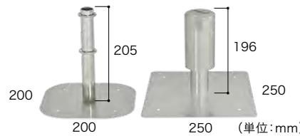
断熱工法に使用する、二重式の平面部用ステンレス製通気材。全体の形状を小型・軽量化したコンパクト設計。70~80m<sup>2</sup>に1カ所の割合で設置。
