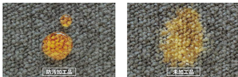
■フッ素系樹脂による防汚加工(SG加工)により汚れを付きにくくします
